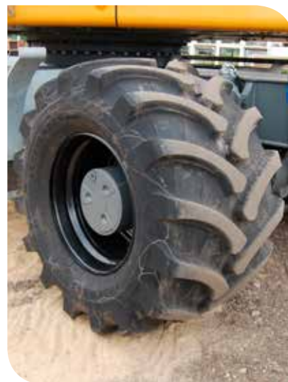
De speciale vorm van de nokken genereert meer tractie en minder insporing.
