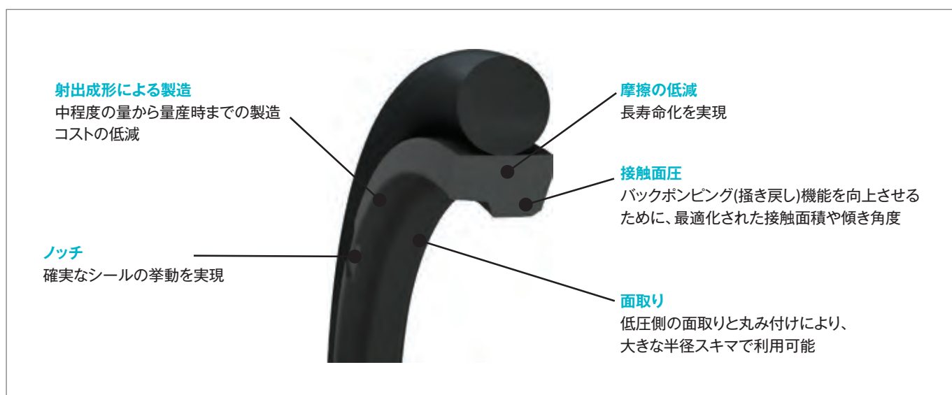
図35: ザーコン® リムシール IMの設計上の特長
