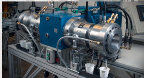
特殊テスト装置により、ロボットアプリケーションにおける急加速および減速の過酷な条件を再現
