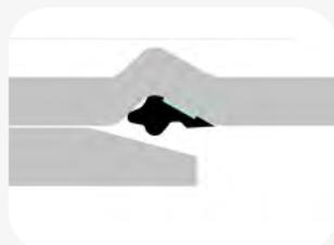
Aplique el lubricante de manera homogénea en el extremo de la espiga.
