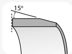
Previo al ensamblaje, inspeccione la espiga y la campana ante posibles daños y elimine eventuales partículas de suciedad. Achaflane la espiga, elimine cualquier posible rebaba.
