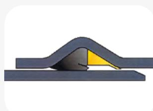
Alinee la espiga y la campana y deslice la espiga en el interior de la tubería hasta el lugar adecuado.
