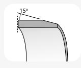
Vérifiez que l'about mâle et la tulipe du tuyau sont en bon état avant de procéder à l'assemblage. Chanfreinez l'extrémité du tuyau et retirez toutes les bavures.
