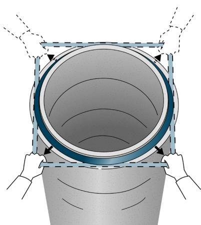
**SE** Jämma ut spänningen i tätningsringen. Lyft på några punkter.
