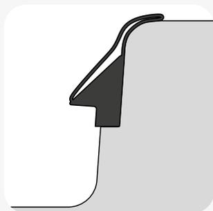
Spannen Sie die Dichtung auf den Vorsprung und positionieren Sie diese gegen die Schulter.
