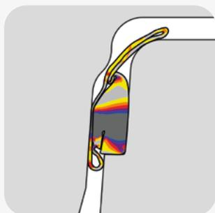
Zusätzliches Gleitmittel ist nicht notwendig. Zentrieren Sie die Verbindung und nehmen Sie die Montage vor. Die Position der Dichtung in der endgültigen Verbindung des Schachts ist abgebildet.
