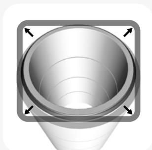
Gleichen Sie die Vorspannung der Dichtung aus, indem Sie sie an ein paar Stellen anheben und wieder loslassen. Die Dichtung muss gleichmäßig an der Schulter des Vorsprungs um das Rohr oder den Schacht herum anliegen.
