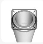
Iguale la tensión de la junta levantándola y soltándola en algunos puntos. La junta debe quedar colocada de manera uniforme sobre la espiga alrededor de la tubería y del pozo de hormigón.
