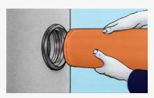
Centre el extremo de la tubería y presiónelo contra la junta, de forma que el extremo de la tubería quede a ras con la pared interior.
