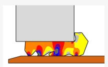
Una vez colocada la tubería, el elemento de caucho se deforma. Ésto crea presión tanto en la espiga como en la campana, asegurando un sellado estanco.
