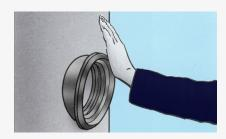
Introduzca la junta en el orificio y presione hasta colocarla en su sitio. No require de lubricación.
