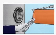
Bisele el extremo de la tubería a conectar y aplique **lubricante Trelle**borg 992.
