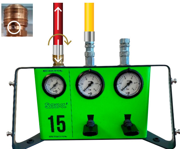
Abbildung 7.14: Den Füllschlauch vom Steuerorgan abtrennen
