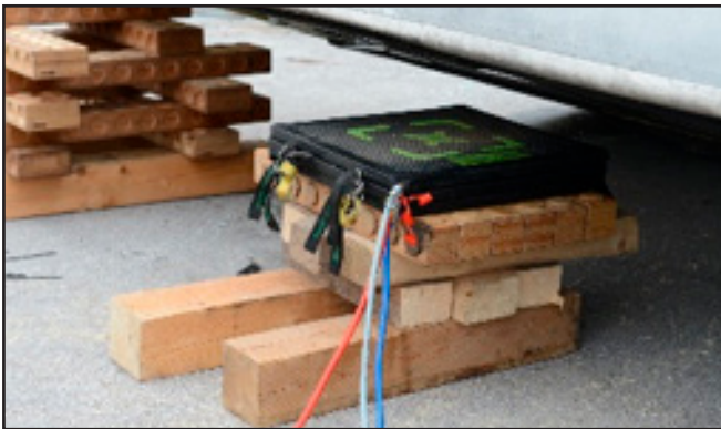
Abbildung 7.6: SAVA-Hebekissen am Ort der Nutzung positionieren
