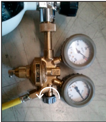
Abbildung 7.13: Lösen des Sicherheitsventils
