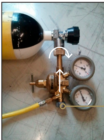
Abbildung 7.10: Den Druckminderer installieren
