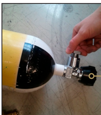
Abbildung 7.9: Den Sicherheitsstift vom Druckbehälter entfernen
