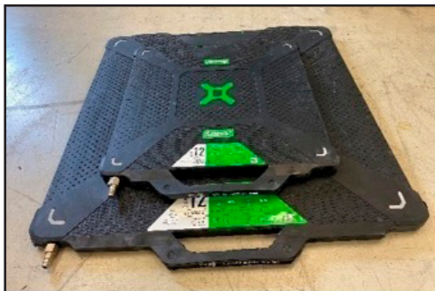
Abbildung 7.24: Kombination von konventionellen SAVA-Hebekissen zur Erhöhung der Hubhöhe
