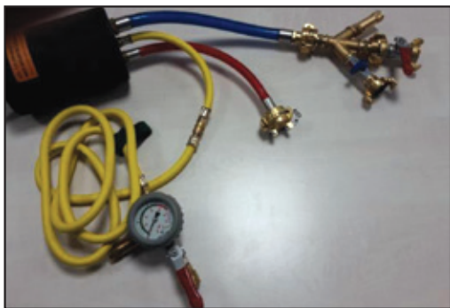
Abbildung 22: Anschluss für Dichtheitsprüfung mit Luft
