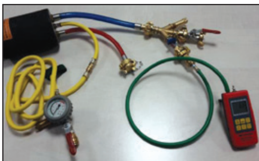
Abbildung 23: Prüfung mit Luft mit einem digitalen Handmanometergauge
