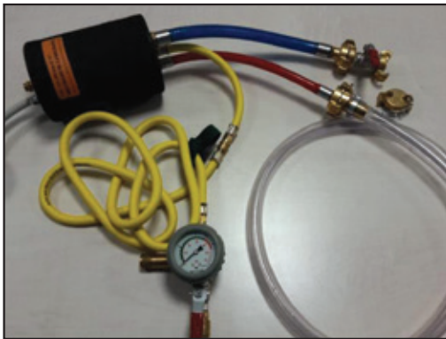
Abbildung 26: Anschluss für Dichtheitsprüfung mit Wasser
