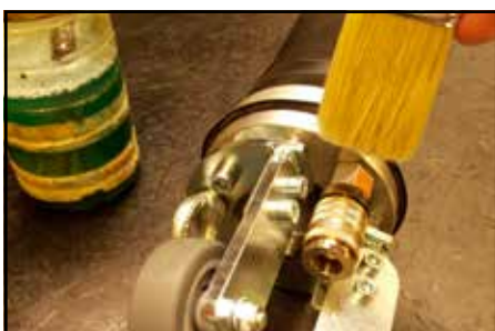
Abbildung 26: Nach Ersetzen der Anschlusskupplung auf Dichtheit prüfen
