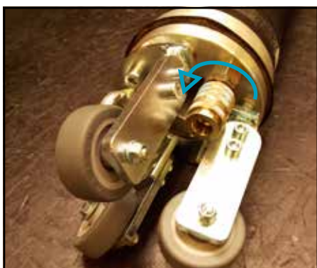
Abbildung 22: Demontage der Anschlusskupplung
