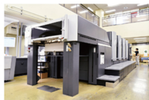
ハイドルベルグ社の 高感度UVオフセット印刷機
