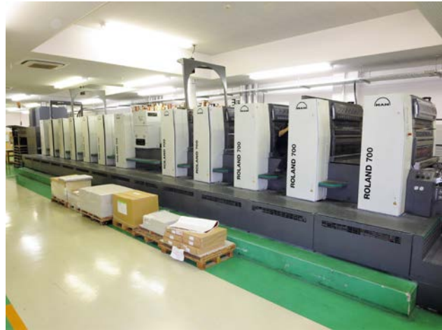
Máquina de impresión Manroland 10-color Roland 700 equipada con una Vulcan Pack UV
