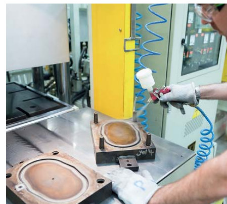
Små sprutpistoler används för applicering av släppmedel före gjutning av elastomerskiktet på tätningar.
