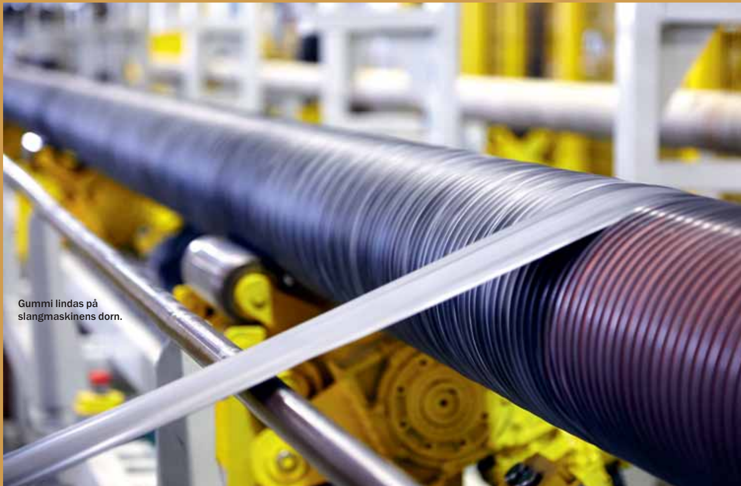
Adem Zengince tillverkar slang på en automatisk linje.
