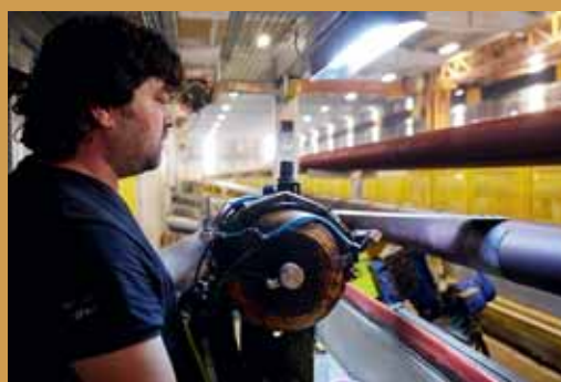
Adem Zengince tillverkar slang på en automatisk linje.
