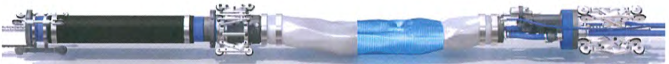
B. Luftleerer Packer nach dem Einführen, vor der Positionierung, Korb oben
