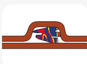
Una vez colocada la tubería, el elemento de caucho se deforma. Ésto crea presión tanto en la espiga como en la campana, asegurando un sellado estanco.
