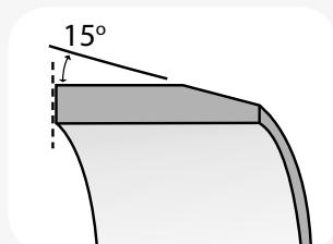
Previo al ensamblaje, inspeccione la espiga y la campana ante posibles daños y elimine eventuales partículas de suciedad. Achaflane la espiga, eliminar cualquier posible rebaba.
