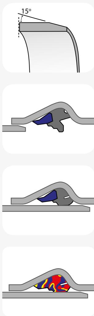
Previo al ensamblaje, inspeccione la espiga y la campana ante posibles daños y elimine eventuales partículas de suciedad. Achaflane la espiga, eliminar cualquier posible rebaba.
