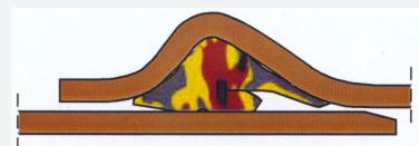
Para dimensiones de hasta 400 mm, el elemento de sellado es elastomero termoplástico y el elemento de retención termoplástico. El material elastomérico cumple el estándar europeo EN 681-2, clase 60.
