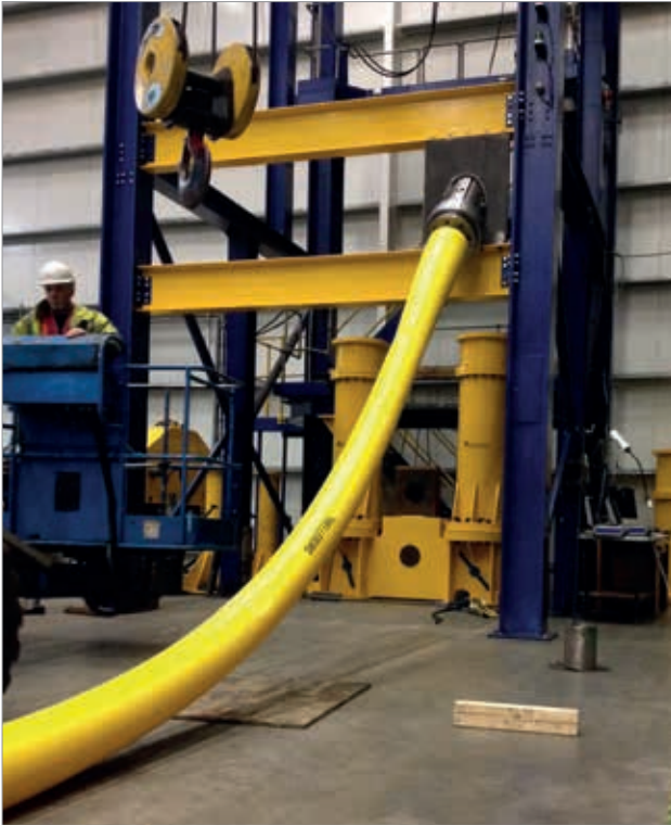
在工厂测试时，将等尺寸的NjordGuard™安装到模拟现场的单桩上
