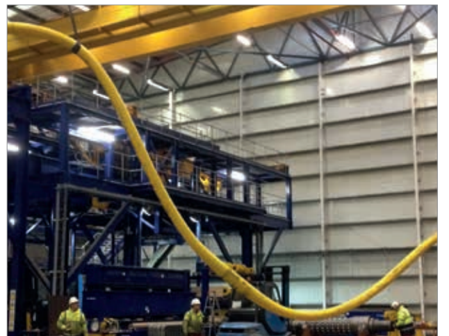
特瑞堡的NjordGuard™电缆集成防护系统在工厂进行全面测试
