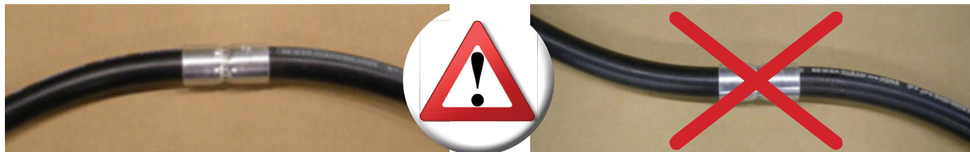
För in den andra slangen. Kontrollera att de två längderna följer slangens naturliga krökning innan pressning/ krympning. Insert the second hose, swaged the second ferrule. Before swaging ensure the 2 Length follow the natural curve of the hose.
