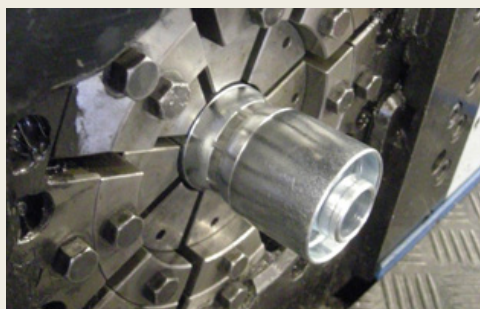
Gör en markering som anger längd L (se tabell). Make a mark indicating the length L. (Refer to table)
