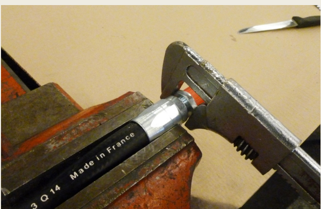
Använd en skiftnyckel för att dra åt skruven. Use a spanner to continue tightening the screw.
