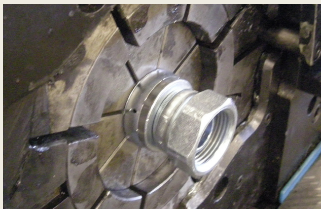
Pressa utan att passera märket. Swage but do not pass the mark.
