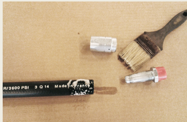
Tvåla in yttrehölje och slangnippel. Apply soap to the hose cover and nipple.
