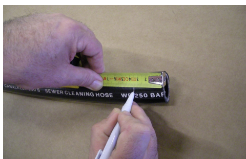
Gör en markering som anger längd L (se tabell). Make a mark indicating the length L. (Refer to table)
