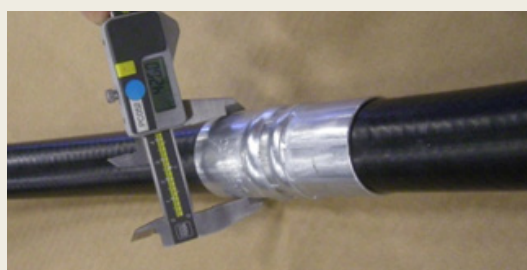
För in den andra slangen. Kontrollera att de två längderna följer slangens naturliga krökning innan pressning/ krympning. Insert the second hose, swaged the second ferrule. Before swaging ensure the 2 Length follow the natural curve of the hose.
