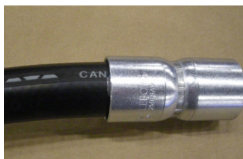
För in slangen till markeringen och se till att det är synligt genom hålet i hylsan. Insert the hose until the mark and ensure you can see it through the ferrule hole.
