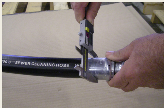
Kontrollera det uppnådda pressmåtten med skjutmått och justera vid behov. Check the swage diameter obtained with a caliper and rectify if necessary.
