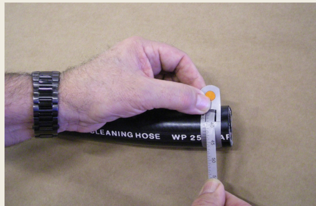
Kontrollera ytterdiametern med ett skjutmått. Check the outer diameter with a circrometer.
