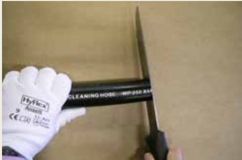
Couper le tuyau parfaitement droit Cut the hose perfectly straight.
