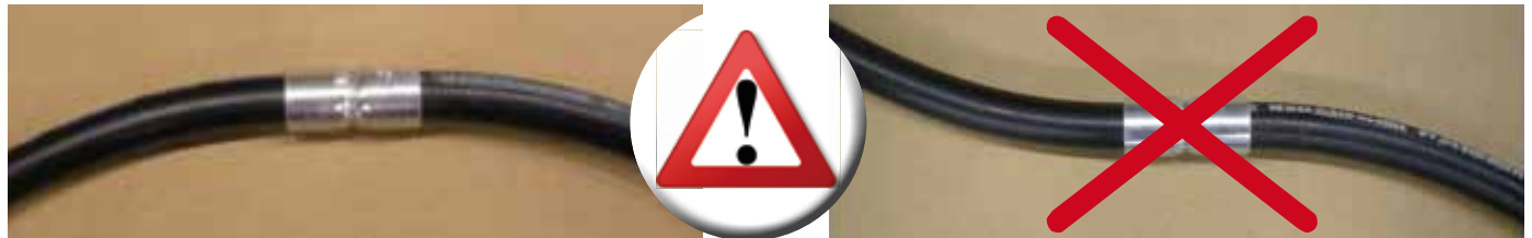
Insérer le deuxième tuyau, sertir la deuxième extrémité. Attention de bien respecter la courbure naturelle du tuyau. Insert the second hose, swaged the second ferrule. Before swaging ensure the 2 Length follow the natural curve of the hose.
