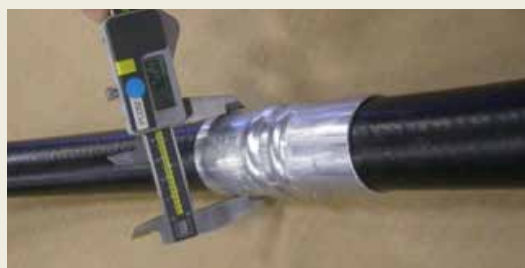
Insérer le deuxième tuyau, sertir la deuxième extrémité. Attention de bien respecter la courbure naturelle du tuyau. Insert the second hose, swaged the second ferrule. Before swaging ensure the 2 Length follow the natural curve of the hose.
