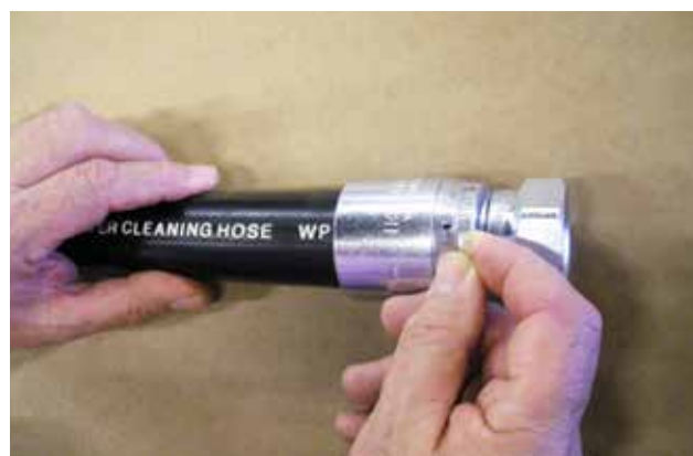
Insérer le tuyau jusqu'au repère et vérifier qu'il est visible par le trou. Insert the hose until the mark and ensure you can see it through the ferrule hole.
