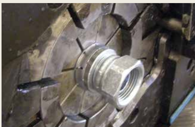
Sertir la jupe jusqu'au repère circulaire. Swage but do not pass the mark.
