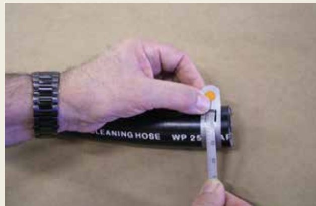
Contrôler le diamètre extérieur du tuyau avec un circomètre. Check the outer diameter with a circometer.
