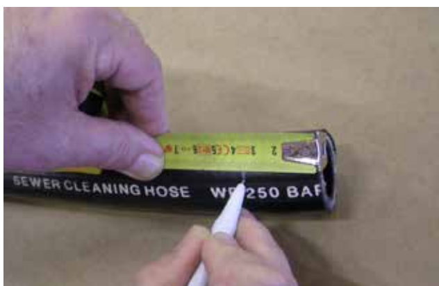
Tracer un trait repère à la distance L. (Voir tableau) Make a mark indicating the length L. (Refer to table)
