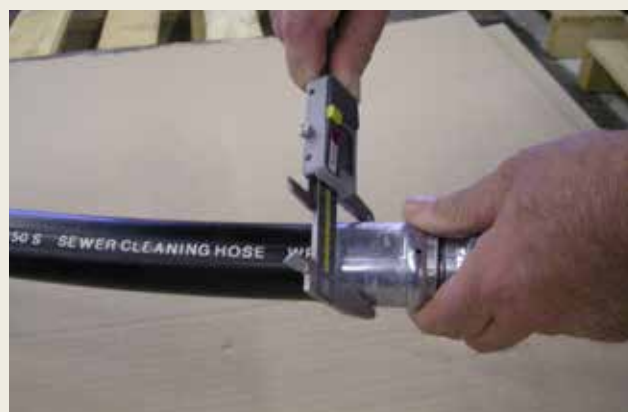
Contrôler le diamètre de sertissage à l'aide d'un pied à coulisse et rectifier si nécessaire. Check the swage diameter obtained with a caliper and rectify if necessary.
