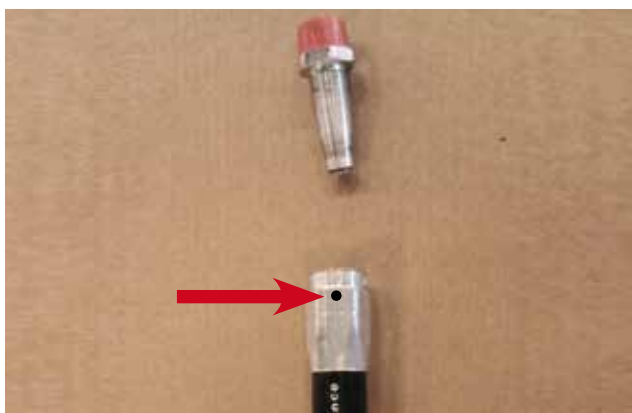
Visser la jupe sur le tuyau jusqu'à ce que le tuyau soit visible par le trou. Twist on the ferrule until the hose becomes visible through the hole.
