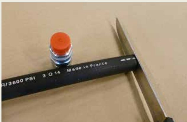
Couper le tuyau endommagé parfaitement droit, chercher une zone saine. Cut the damaged part perfectly straight, find a clean section.
