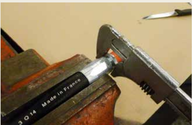
Utiliser une clef pour poursuivre le serrage. Use a spanner to continue tightening the screw.
