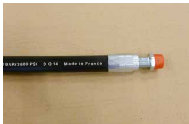
Commencer à visser la douille dans la jupe. Start to screw the nipple into the ferrule.
