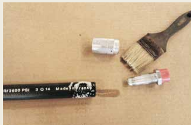
Enduire de savon le revêtement du tuyau et la douille du raccord. Apply soap to the hose cover and nipple.
