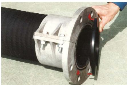
Monter le joint en engageant les 2 goupilles dans les logements prévus à cet effet dans la face du raccord Bloc-End (flèches rouges).
