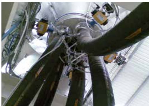
Transport de microsilice Alimentation de 5 lignes de fabrication à partir du même silo.
