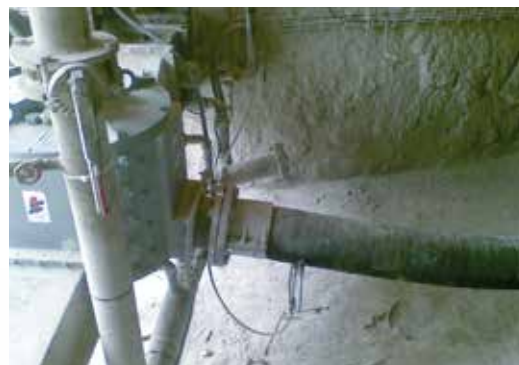
Transport de microsilice Alimentation de 5 lignes de fabrication à partir du même silo.
