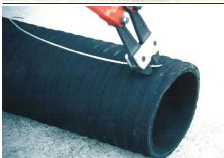
Cintrer la spire métallique de 90° par rapport à l'onde du tuyau puis la sectionner à l'aide d'une pince coupante ou d'une scie à métaux en la laissant dégagée de 1 centimètre du revêtement.
