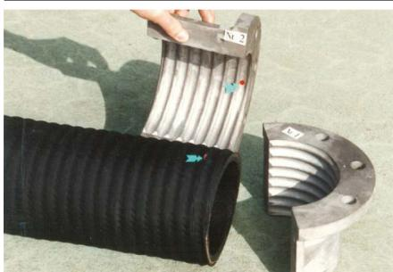
Positionner la 1/2 coquille repérée de façon à placer l'extremité de la spire métallique dans le creux de la première onde du raccord côté bride (flèches vertes).
