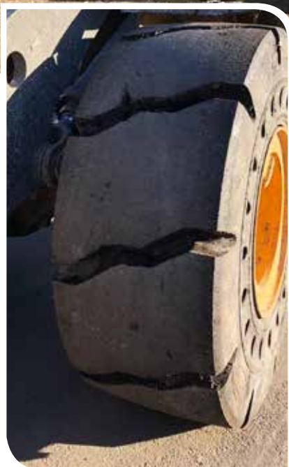
Yhteen koneeseen asennettiin neljä uutta erikoisrakenteista rengasta, ja tulos oli selkeä. Luisto hävisi heti.
