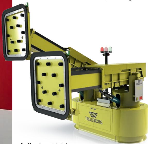
Arriba: La unidad de amarre automático sin cabos AutoMoor T40 Twin Arm.
