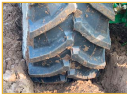
La linea TM900 High Power garantisce una perfetta autopulitura in 1,5 rotazioni
