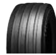
Pneu agricole à profil ligné destiné au labour.
