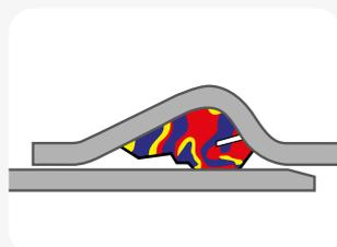
Im montierten Zustand kommt es zur Verformung der Dichtung, wobei sie so konstruiert ist, dass es zur gleichmäßigen Druckverteilung auf Muffe und Spitzende kommt.
