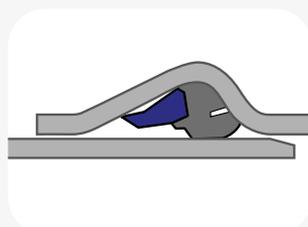
Das Spitzende wird bis zum Anschlag in die Muffe geschoben.
