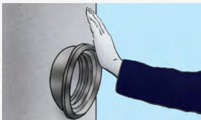
Dichtung in Bohrlochung eindrücken ohne Zugabe von Gleitmittel.
