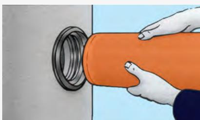
Der im Dichtungssystem eingebaute Montagestop verhindert das Durchschieben des anzuschließenden Rohres.
