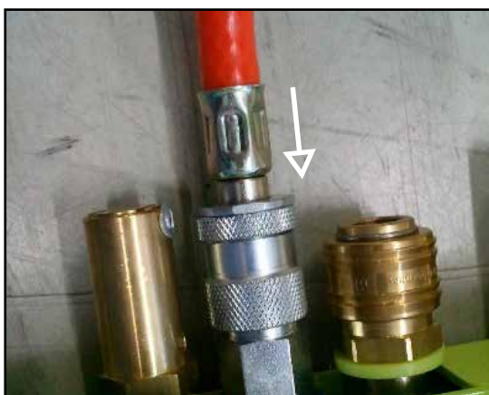
Abb. 5.4: Anschließen von Verbindungsschläuchen an das Steuerorgan
