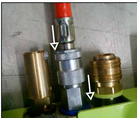
Abb. 5.18: Abtrennen der Verbindungsschläuche vom Steuerorgan
