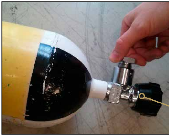
Abb. 5.5: Entfernung des Sicherheitsstiftes vom Druckbehälter
