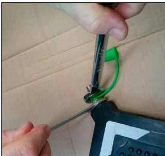
Abb. 6.1: Ersetzen des Anschlusssteils am SAVA Hebekissen
