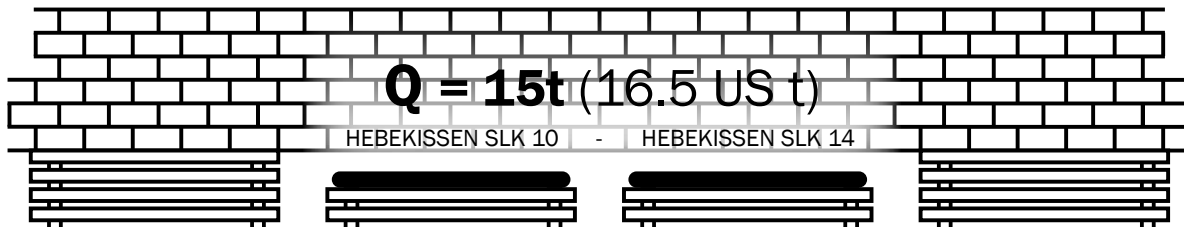
Abb. 5.25: Kombination zweier nebeneinandergelegte SAVA Hebekissen erhöht die Hubleistung
