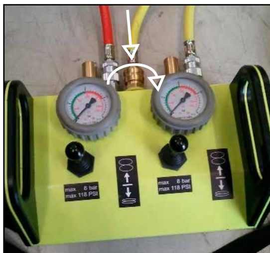
Abb.5.8: Anschließen des Füllschlauches ans Steuerorgan
