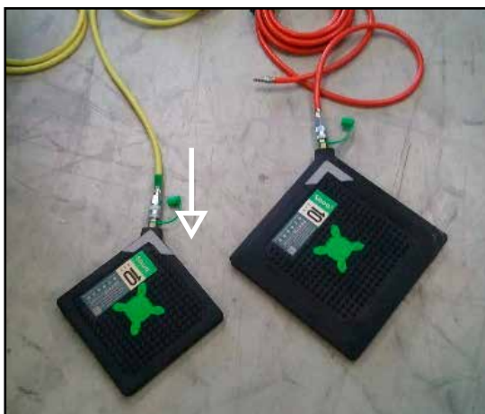
Abb. 5.3: Anschließen vom Schlauch an das SAVA Hebekissen
