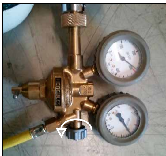
Abb. 5.9: Entlasten des Druckminderventils
