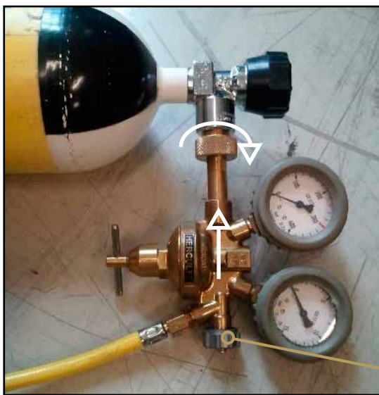
Abb. 5.6: Aufbringung des Druckminderventils
