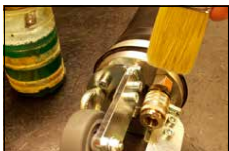
Slika 26: Kontrola tesnjenja po zamenjavi priključne spojke.
