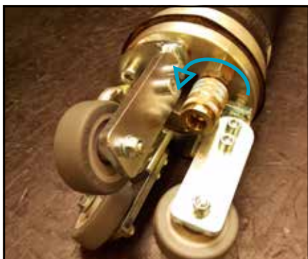
Slika 22: Demontaža priključne spojke.
