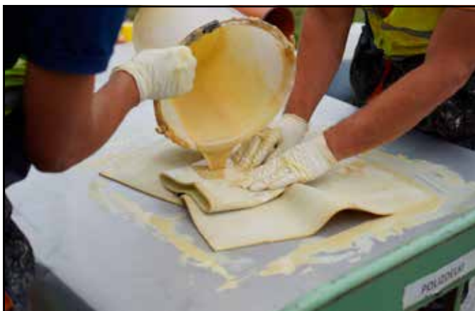
Slika 17: Nanos vlaken s smolo na zaščiten T paker SAVA.
