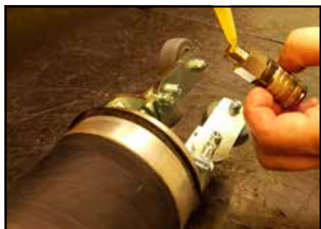
Slika 23: Nanes tesnilnega lepila.
