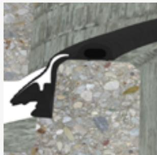
Wenn die Fügung wieder auseinandergebaut werden muß, ist unbedingt darauf zu achten, dass vor erneuter Durchführung des Fügevorganges der Gleitmantel der Dichtung in die Ursprungposition zurückgezogen wird.
