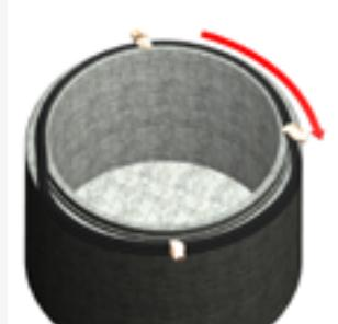
Den Schachtring zentrieren und die Muffe über den Dichtring heruntergleiten lassen.
