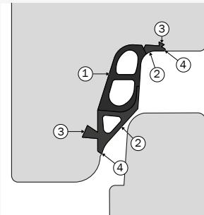
spezielle Lippendichtung dichtet zur Untermuffe ab und verhindert das Eindringen von Beton zwischen Muffe und Dichtung während der Schachtringproduktion. Die Lippen bestehen aus weichem Kautschuk der Härte 40 IRHD und haben eine hervorragende Dichtwirkung.
