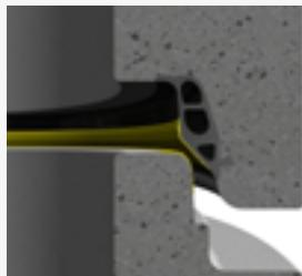
Die Muffe muß bei der Verbindungsherstellung sauber zentriert werden, um eine gute Dichtigkeit zu gewährleisten.
