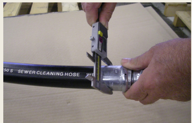
Überprüfen Sie den Pressdurchmesser mit einer Schieblehre und passen Sie ihn, falls notwendig, an. Check the swage diameter obtained with a caliper and rectify if necessary.
