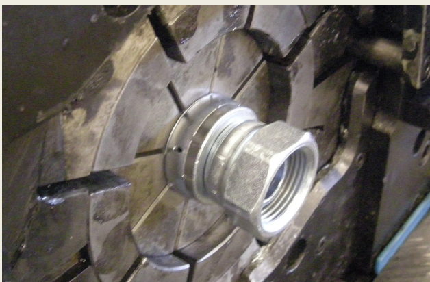
Verpressen Sie die Hülse ohne Überschreitung der Markierung. Swage but do not pass the mark.
