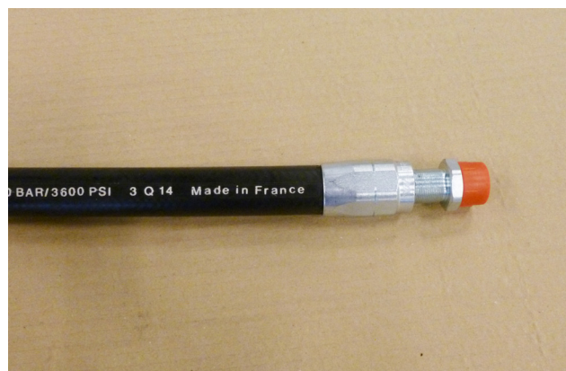
Beginnen Sie, den Nippel in die Hülse einzudrehen. Start to screw the nipple into the ferrule.
