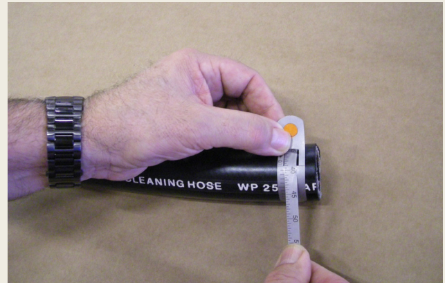
Überprüfen Sie den Außendurchmesser mit einem Circometer. Check the outer diameter with a circometer.
