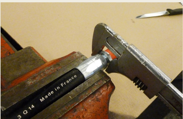
Verwenden Sie zum Einschrauben einen Schraubenschlüssel. Use a spanner to continue tightening the screw.
