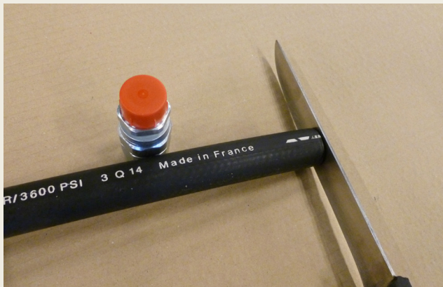
Beim defekten Schlauch bis in den trockenen Bereich kürzen. Cut the damaged part perfectly straight, find a clean section.
