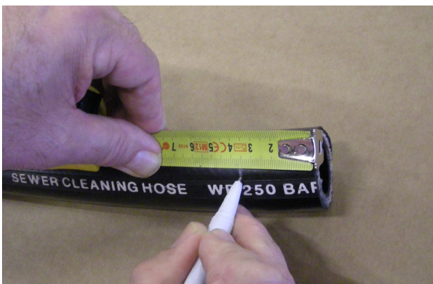
Markieren Sie die Länge (sieheTabelle). Make a mark indicating the length L. (Refere to table)
