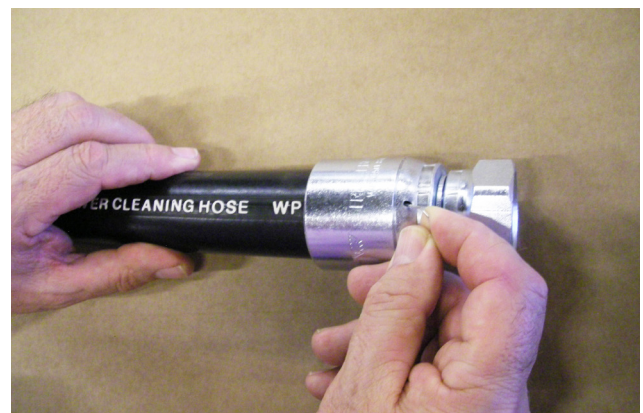
Führen Sie den Schlauch bis zur Markierung ein, bis dieser durch das Loch sichtbar ist. Insert the Hose until the mark and ensure you can see it through the ferrule hole.
