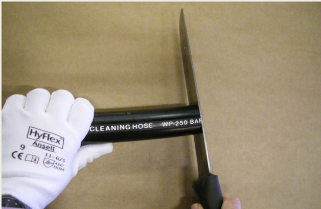
Schneiden Sie den Schlauch vollkommen gerade ab. Cut the Hose perfectly straight.
