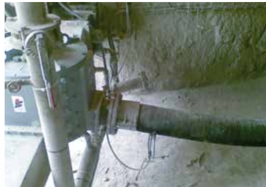
Förderung von Quarzsand Beschickung von 5 Produktionssträngen von nur einem Silo aus.
